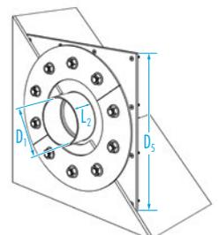
Variante: Curaflex® Futterrohr 7006 / T – Geteilte Ausführung, zur Installation bei vorhandener Rohrleitung.
